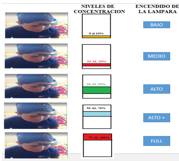
Fig. 9. Condiciones de Encendido de la lámpara para el reto 1.
